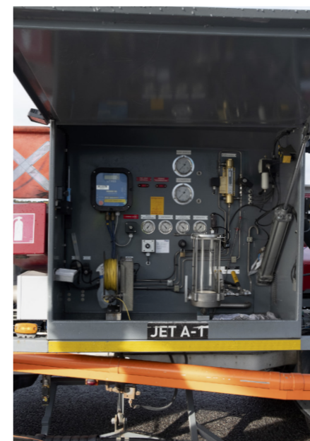
Flygplanen tankas med Jet A-1. I den lilla cylindern kommer ett bränsleprov upp, i den görs en okulär kontroll att allt ser okej ut.
