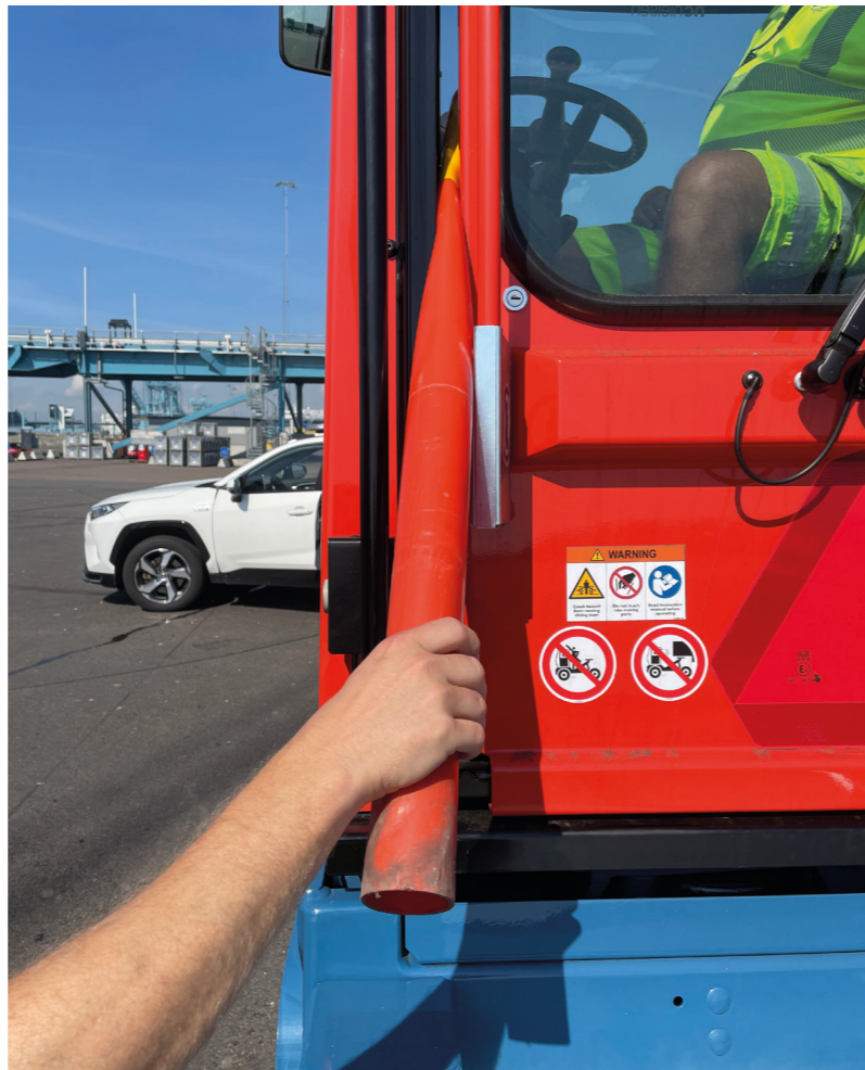
"Här skulle jag inte sticka in en hand", säger regionala skyddsombudet Roger Jönsson som testade med en plastkon i dörröppningen efter justeringen.
