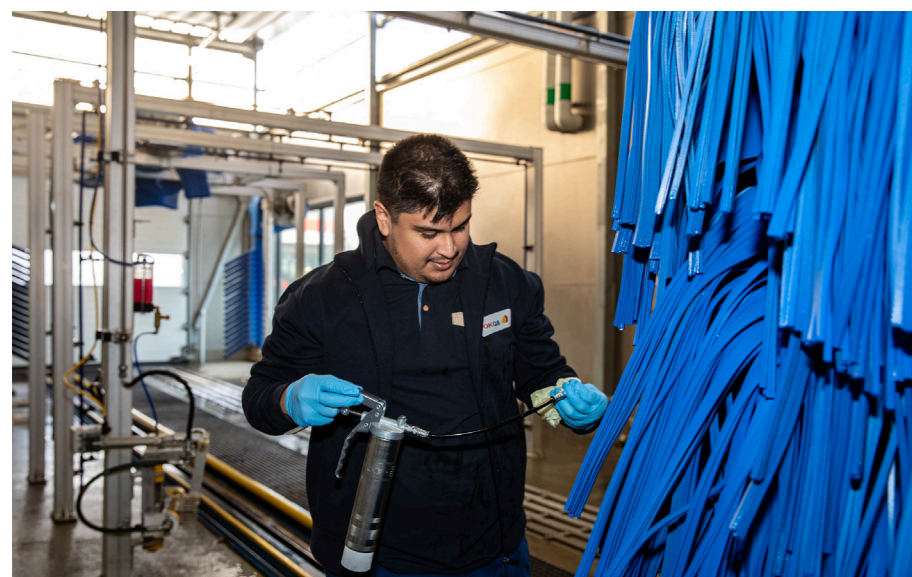
Emilio Orrego jobbar i tvätthallen, sköter driften, smörjer och byter delar när det behövs.
